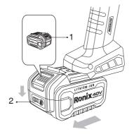
برای جداکردن پک باتری از ابزار، دکمه فشاری را به پایین بفشارید و پک باتری را درجهت نشان داده شده شکل۱ حرکت دهید.
